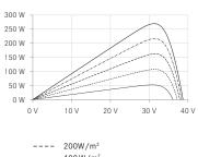
400 W/m<sup>2</sup> 600 W/m<sup>2</sup> 800 W/m<sup>2</sup> 1000 W/m<sup>2</sup>
